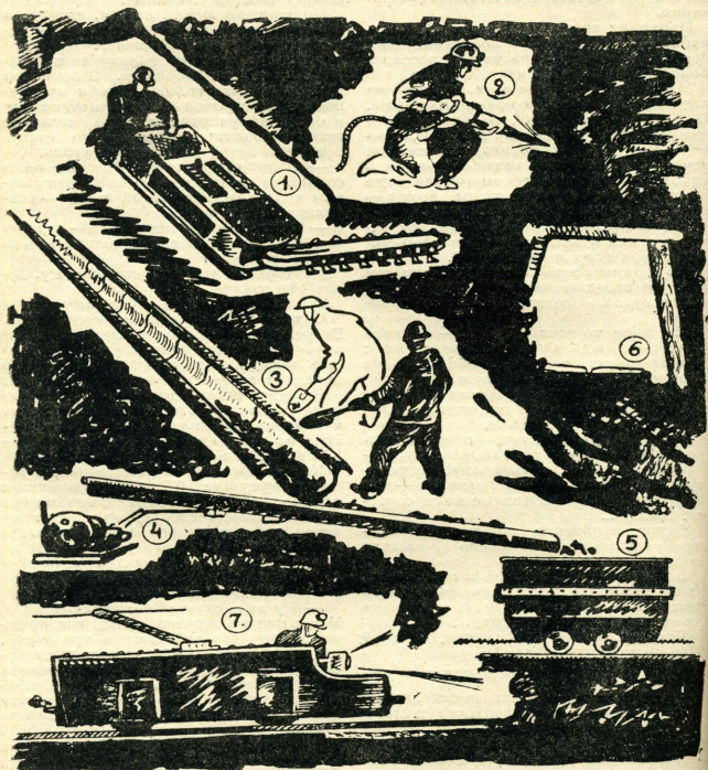
1. Цепная врубовая машина. 2. Работа отбойным молотком. 3. Подача угля по конвейеру. 4. Конвейерный мотор. 5. Нагрузка углем вагонетки посредством конвейера. 6. Штрек. 7. Электровоз.
